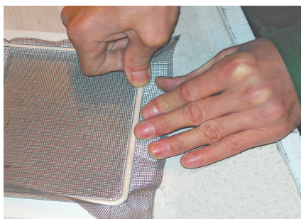
8. Аккуратно заправить край шнура в паз основного профиля.
